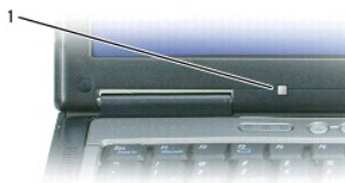
1 sensore di luminosità ambientale
